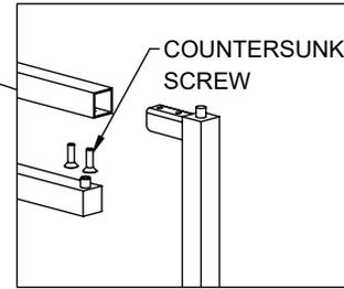
JOIN THE 2 SIDE FRAMES TO THE SWIVEL HANGBAR USING (4) COUNTERSUNK SCREWS. **NOTE: THE HOLES ON THE HANGBAR SHOULD BE FACING UP.**
